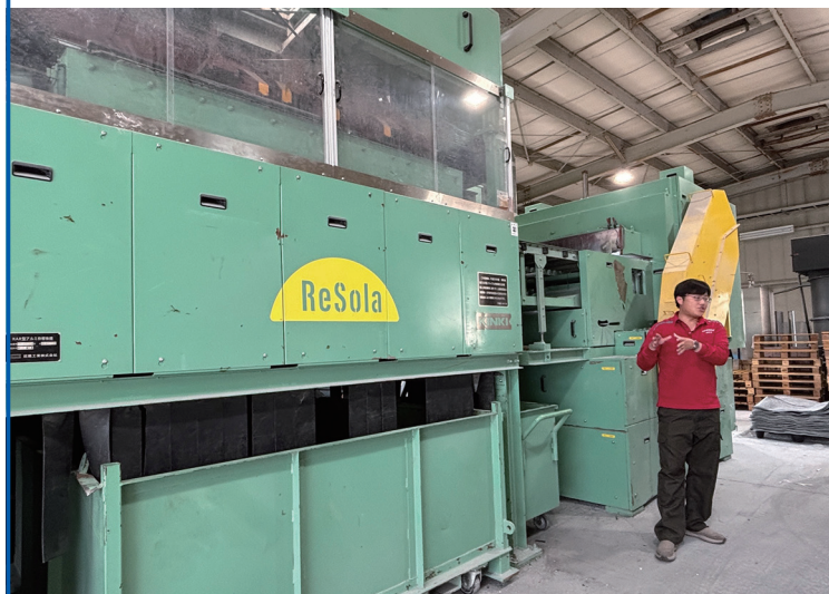
近畿電電輸送の太陽光パネル解体機を前に、パネルリサイクルについて説明する岩崎竜己さん。この機械は1枚のパネルを約2分で解体する
