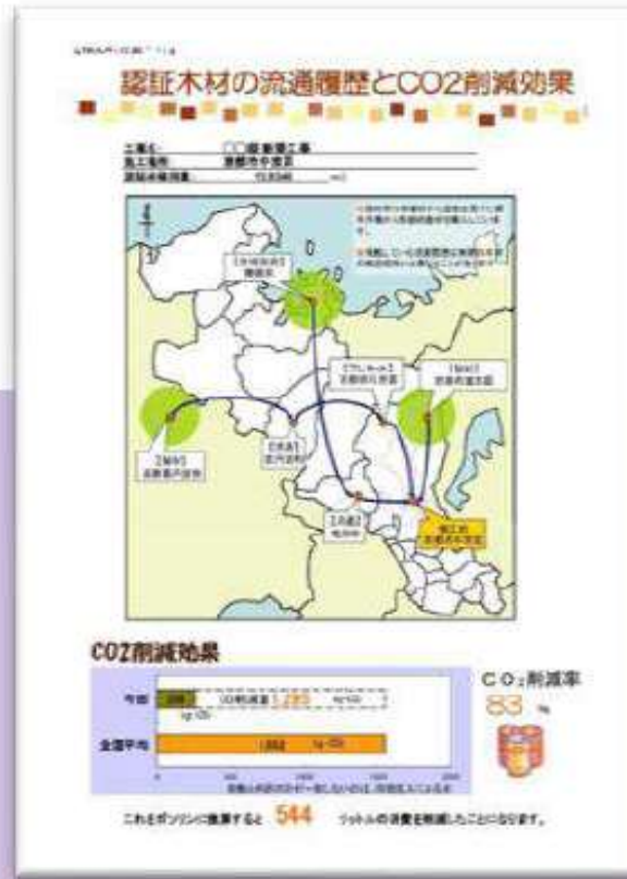
京都府産木材認証制度による ウッドマイレージの削減
